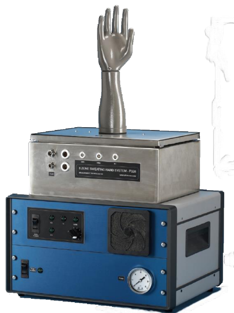
Obr. 3.4 Měřicí zařízení pro určení tepelného odporu [14]
