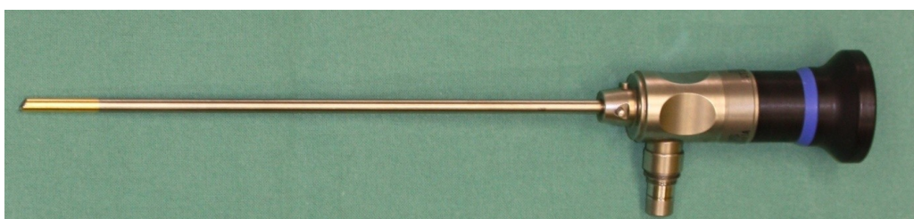
Obr. 13: Tubusový endoskop o průměru 4mm, s 30° pohledovým úhlem, používaný k endoskopiím maxilární dutiny
