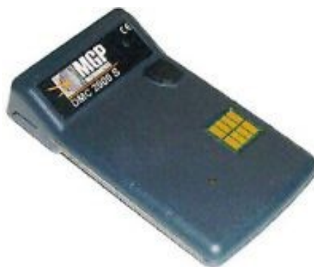
Obrázek 3: Elektronický osobní dozimetr MDC 2000S
