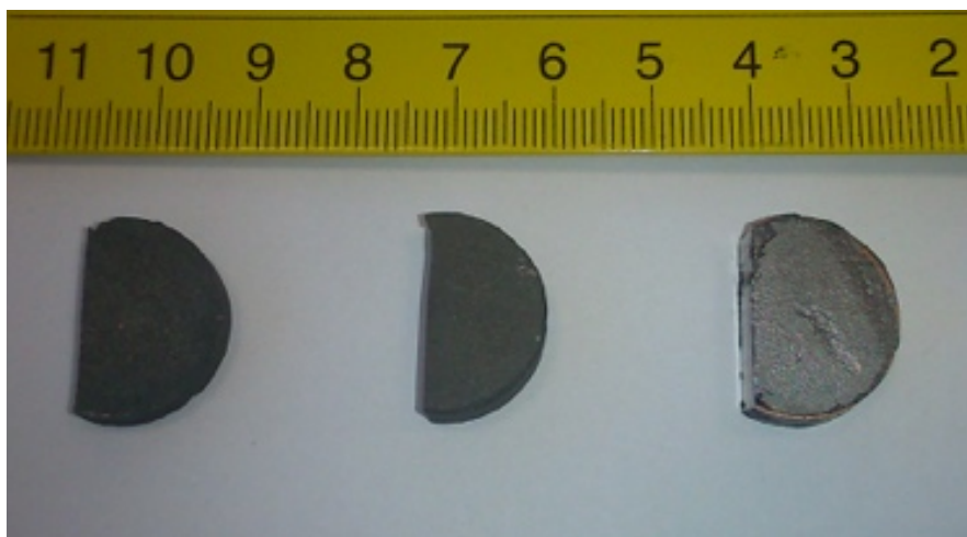
Obr. 16 : Experimentální materiál zleva: FeAl (60:40 at.%), FeAl (40:60 at.%), FeCu (50:50 at.%)
