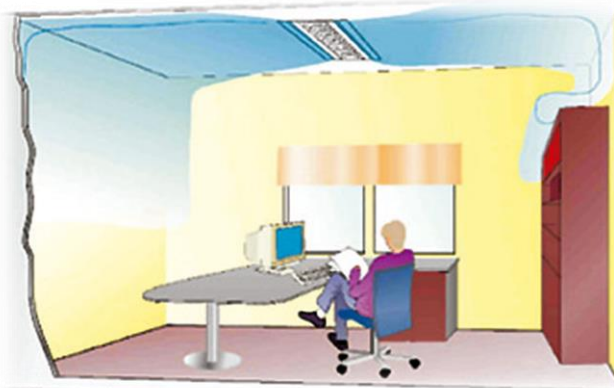
Obrázek 7 – Umístění IJ kolmo k fasádě [25]
