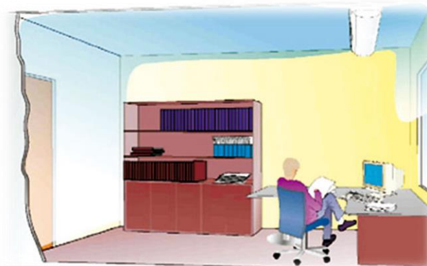
Obrázek 8 – Umístění IJ rovnoběžně s fasádou [25]
