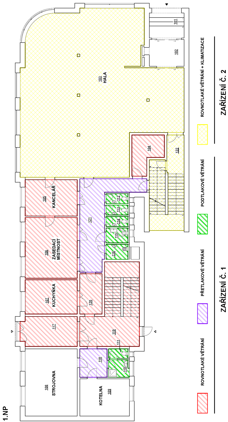
Obrázek 25 - Rozdělení 1.NP na funkční VZT celky a tlakové poměry
