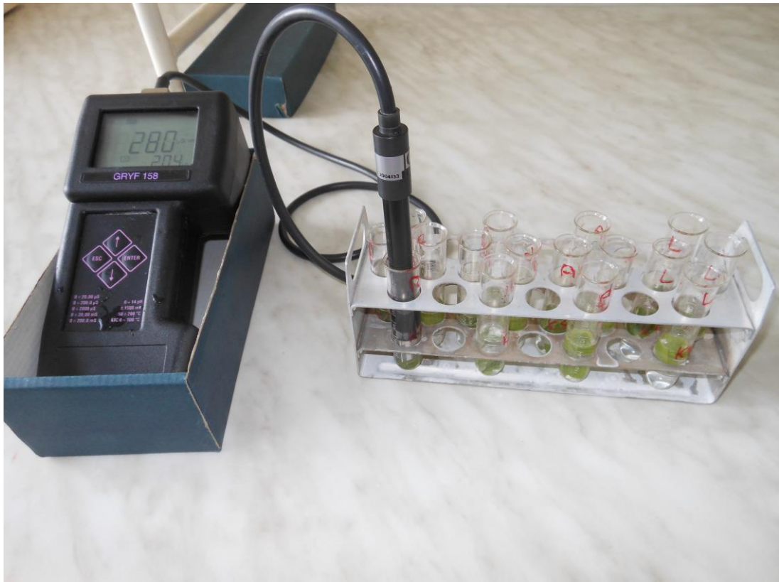
Obr. VII Měření vodivosti pomocí konduktometru (foto autor)
