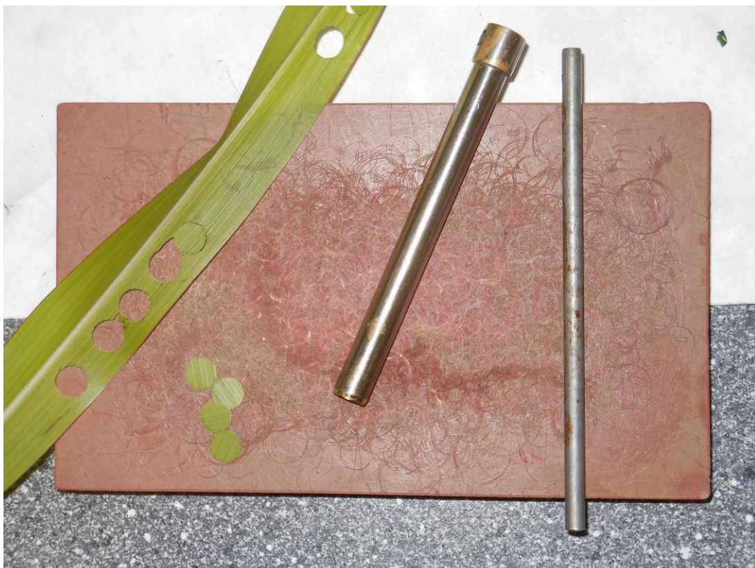
Obr. V Příprava terčičků pomocí korkovrtu (foto autor)
