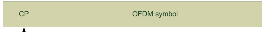
Obr. 1.30: Princip přidání cyklického prefixu k OFDM symbolu
