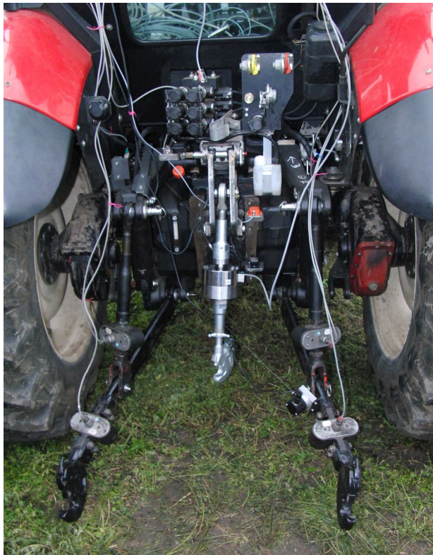
Obr. 4.3 - Umístění snímačů sil v táhlech TBZ, na traktoru Zetor Proxima Plus 115 (Bauer a kol., 2010)
