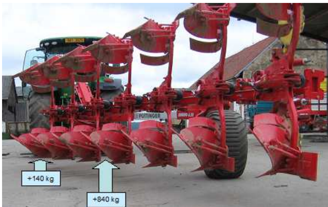
Obr. 4.12 – Vážení orební soupravy při tlaku ve válci 150 bar (Bauer, 2013)
