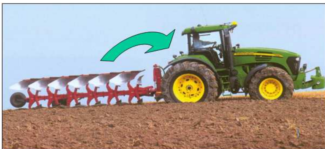
Obr. 2.5 – Dotěžování traktoru pomocí přenosu části tíhy pluhu na zadní nápravu (Bauer a kol., 2013)
