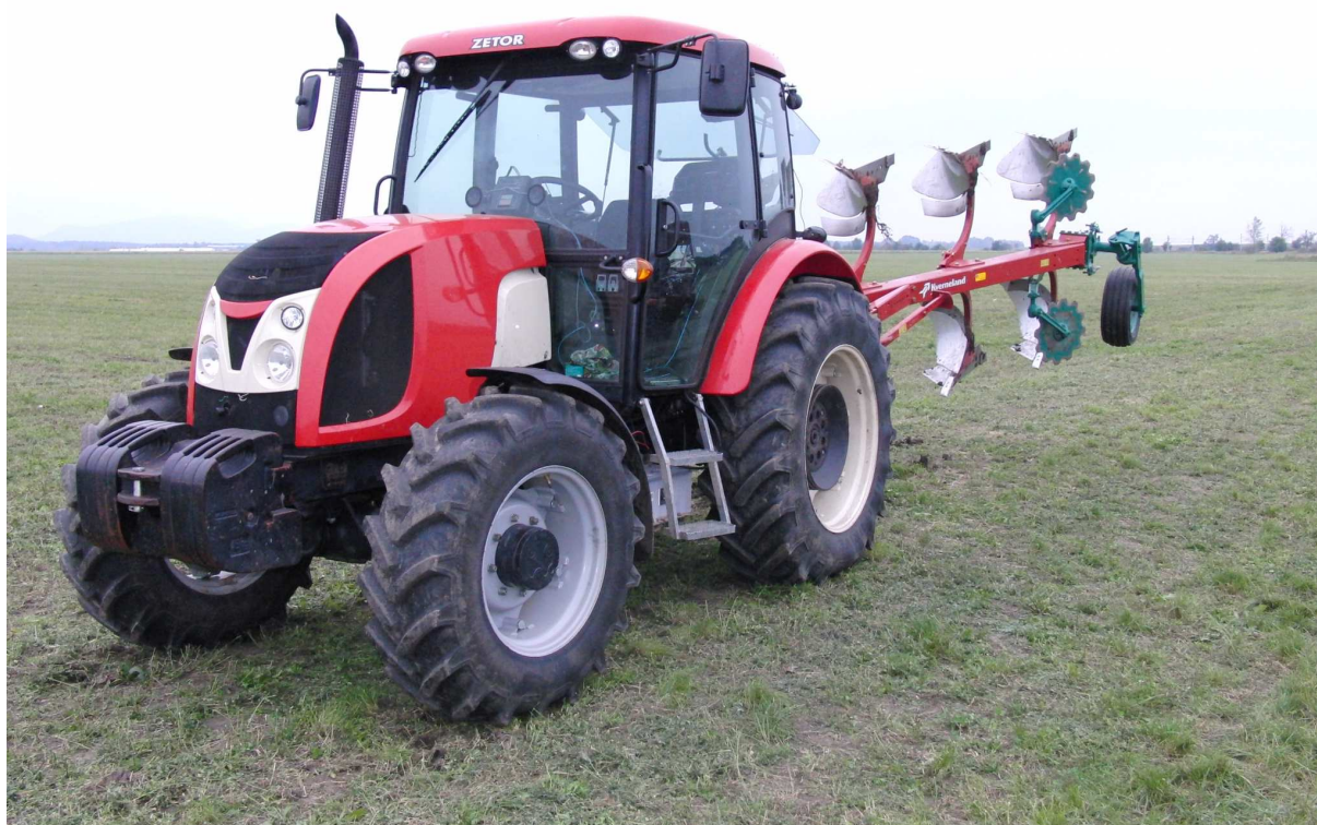
Obr. 4.1 - Zetor Proxima Plus 115 v agregaci s neseným pluhem Kverneland 150B (Bauer a kol., 2010)
