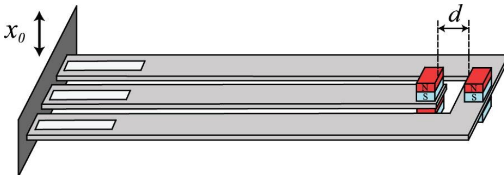
Obr. 11: Schéma konštrukcie 2 nosníkov votknutých na spoločnej strane [9]
