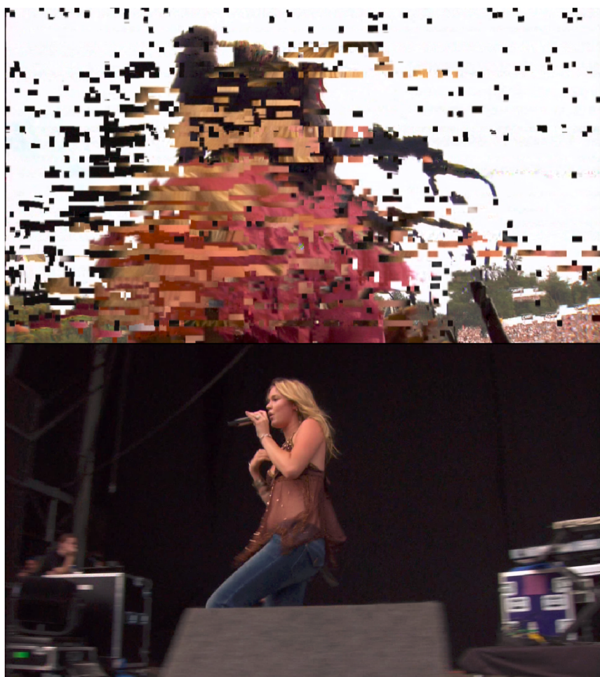
Obr. 3.9: Porovnání multicastu, nahoře bez a dole s podporou QoS.
