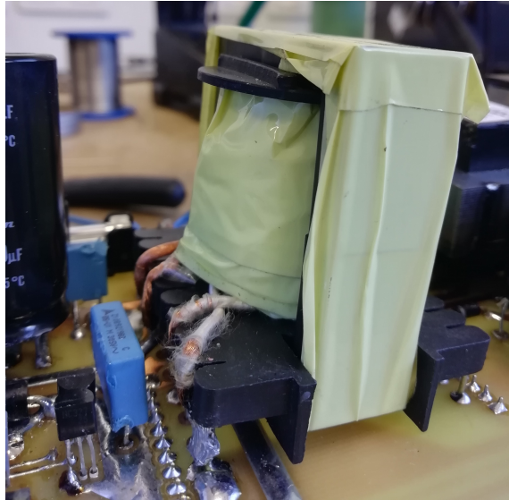
Obr. 4.2: Zhotovený impulsní transformátor.
