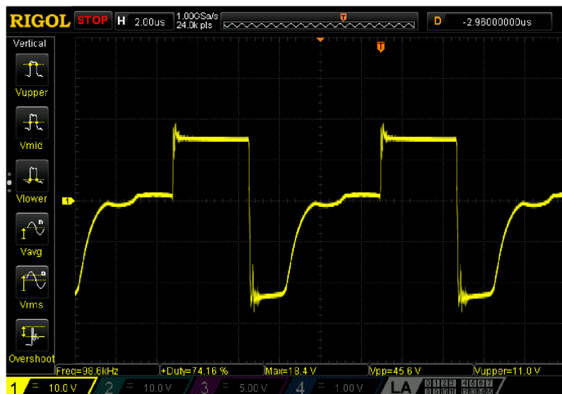
Obr. 4.7: Průběh sekundárního napětí budicího transformátoru.
