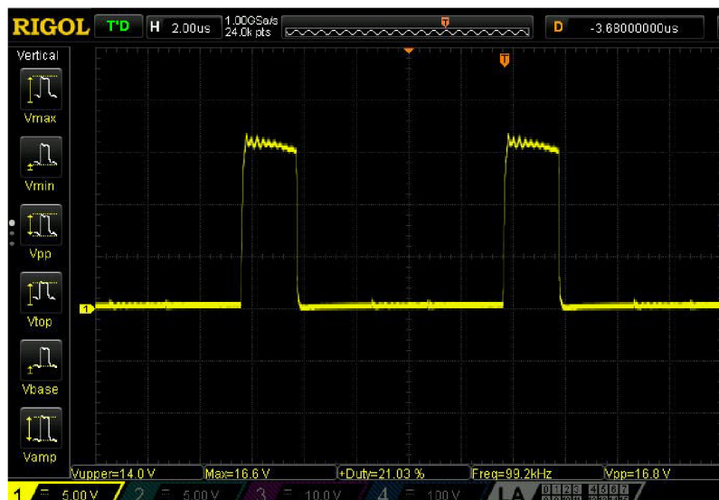
Obr. 4.5: Průběh výstupního napětí PWM modulátoru SG3525ADWR2G.
