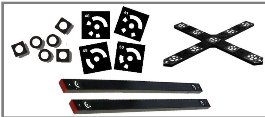
Obr. 3-3 Nekódované a kódované body, orientační kříže a měřítkové tyče [7]
