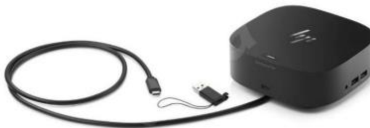
Obrázek 21 dokovací stanice HP-USB-C; slouží pro nabíjení notebooků řady G6 a vyšší; Zdroj: dostupné z firemního intranetu GCP
