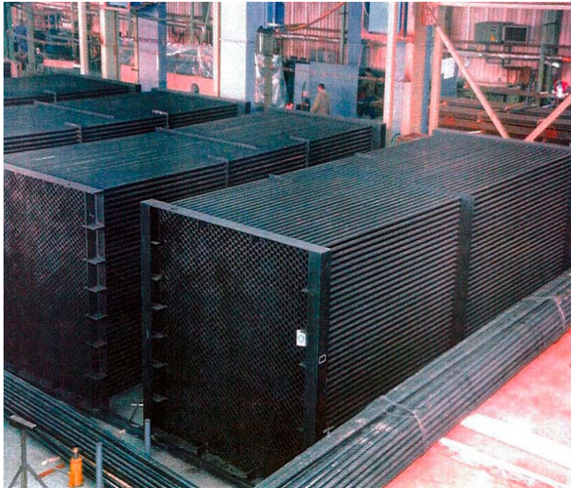
obr.1-15: Ohříváky vzduchu- rekuperační trubkový [10]
