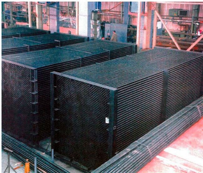
obr.1-15: Ohříváky vzduchu- rekuperační trubkový [10]
