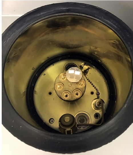
Obrázek 11: Komora zlatičky s vloženým terčíkem s vzorkem materiálu PCL45
