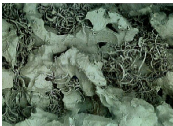
Obr. 4.20 Porezita brousicího kotouče [13].
