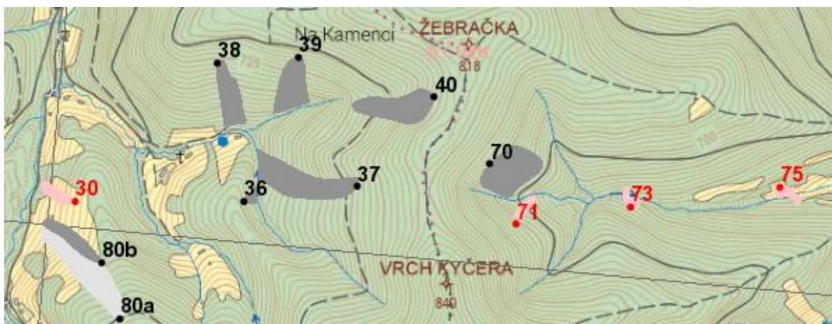
Obr. 9: Svahové nestability v lokalitě Kyčera – Žebračka – Hutisko-Solanec; zdroj: Svahové deformace (geology.cz)
