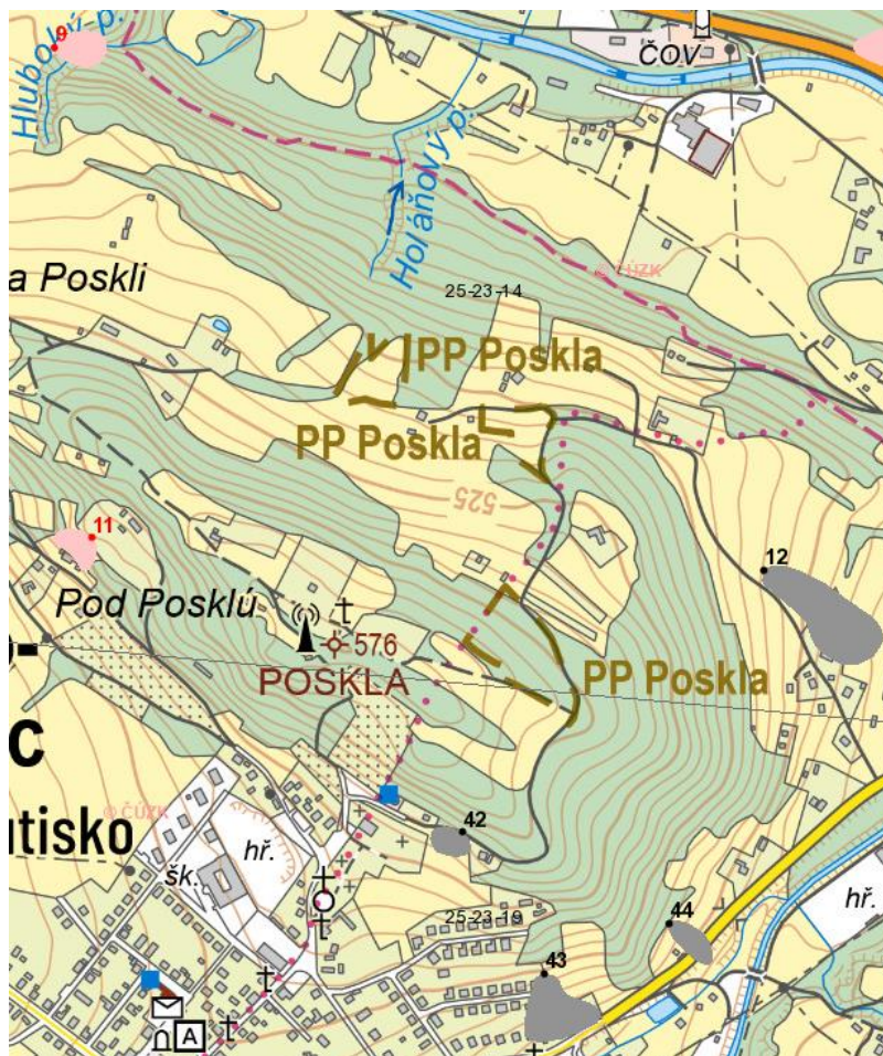
Obr. 11: Svahové nestability v lokalitě Poskla – Hutisko-Solanec; zdroj: Svahové deformace (geology.cz)
