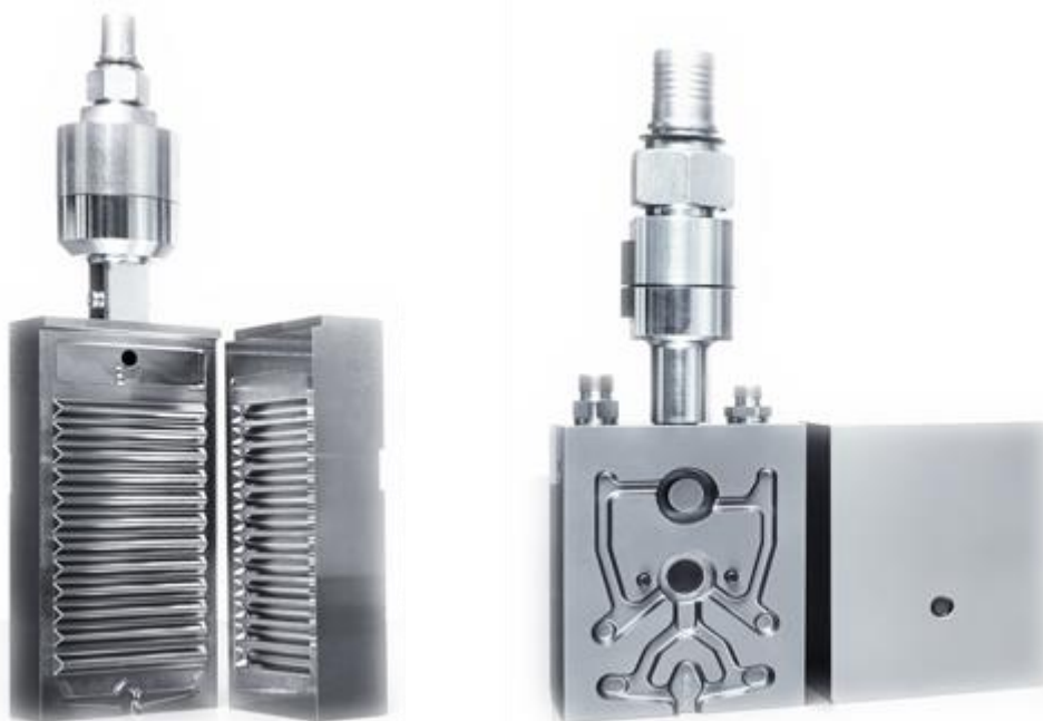
Obr. 18 – Odsávaná valcha a vakuový ventil [47]
