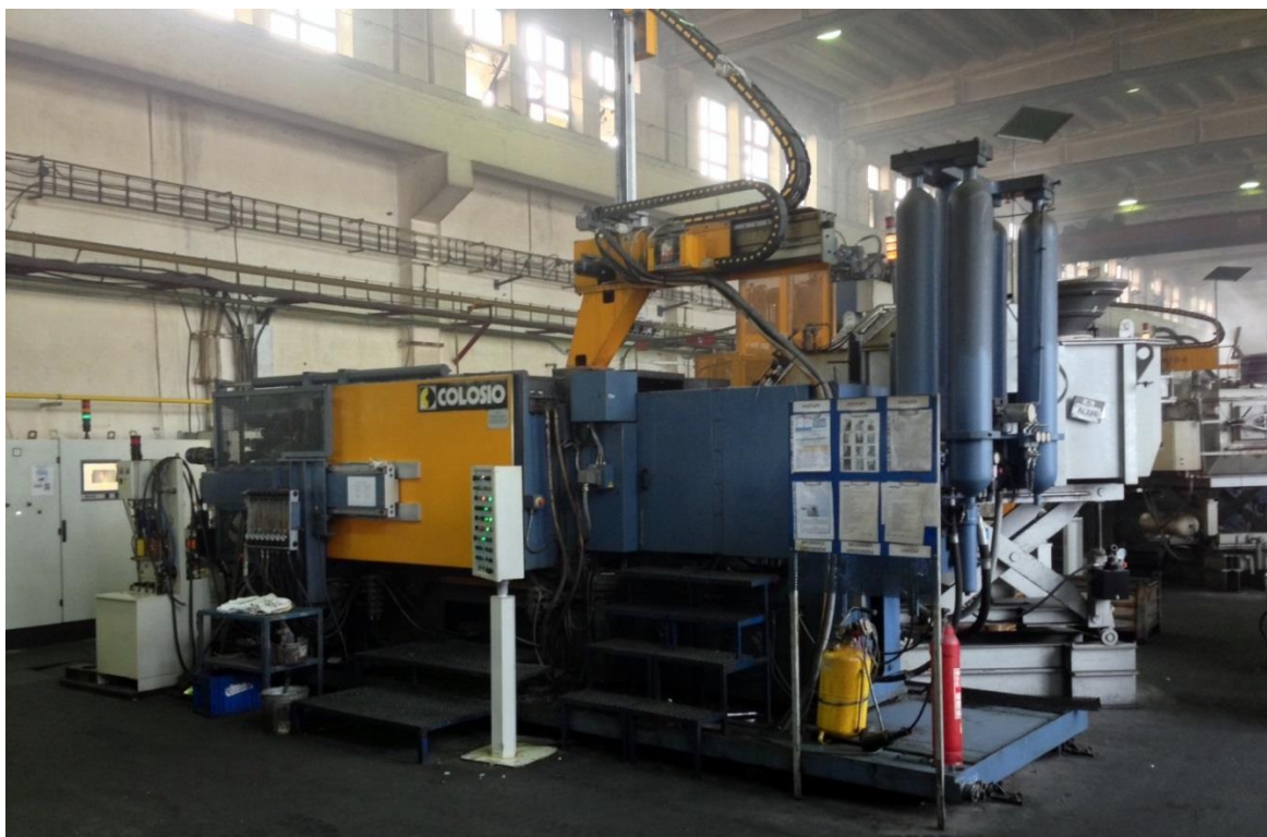
Obr. 14 – Tlakový licí stroj Colosio PFO 560 ve firmě MOTOR JIKOV Slévárna a.s.
