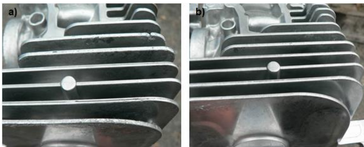
Obr. 44 – Srovnání dosažené kvality spalovacího prostoru válce při rozdílných lisovacích rychlostech v druhé fázi lisování – a) 2 m/s, b) 3 m/s, c) 3,5 m/s
