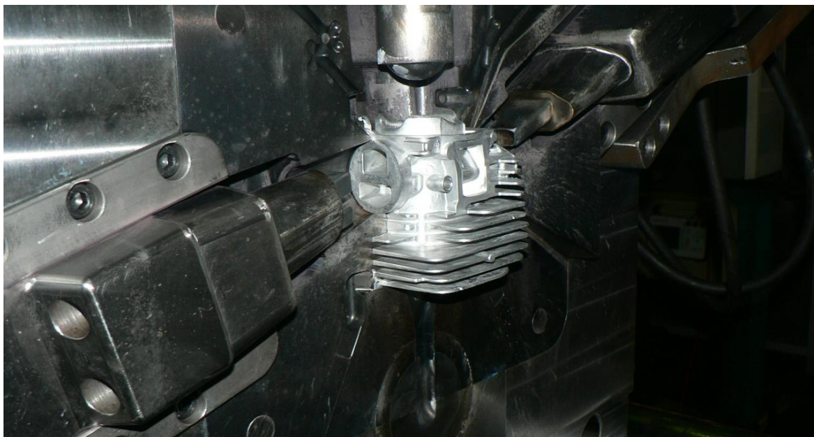
Obr. 34 – Odlitek, který uvízl v pohyblivé části formy
