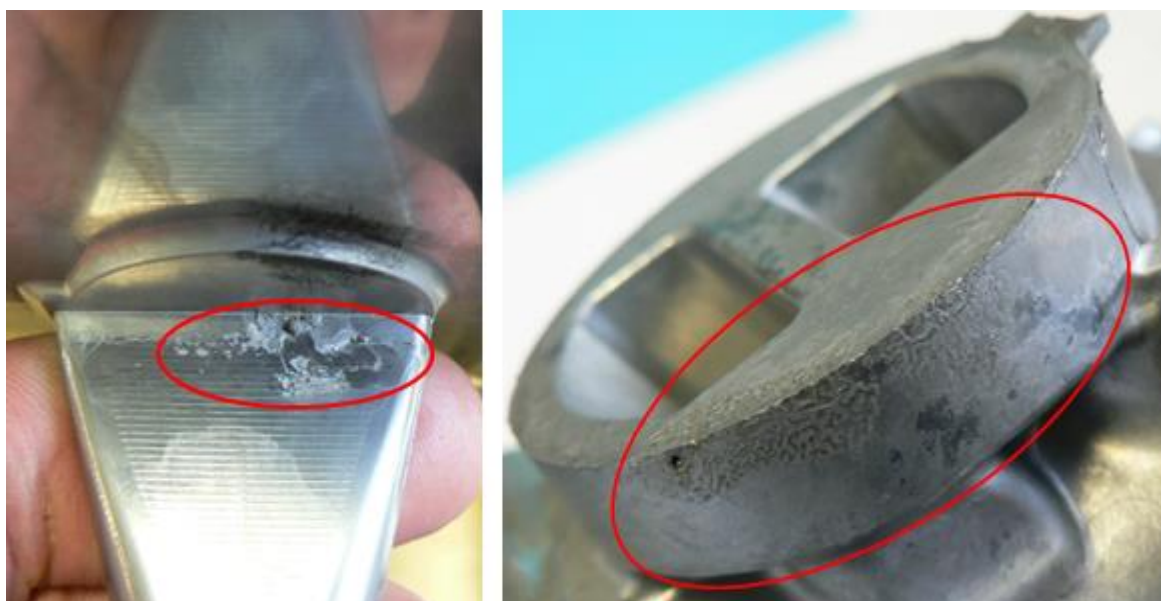
Obr. 47 – Navařený vtokový zářez a nečistoty na povrchu odlitku
