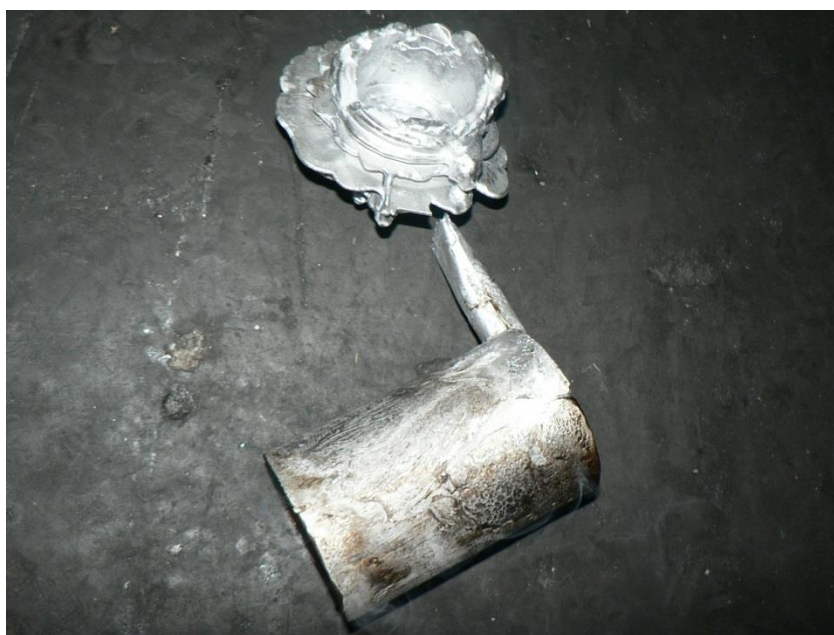
Obr. 21 – Torzo odlitku s vtokovou soustavou
