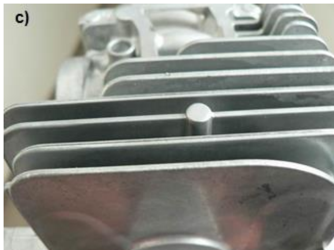
Obr. 45 – Srovnání dosažené kvality žebíř valce při rozdílných lisovacích rychlostech v druhé fázi lisování – a) 2 m/s, b) 3 m/s, c) 3,5 m/s
